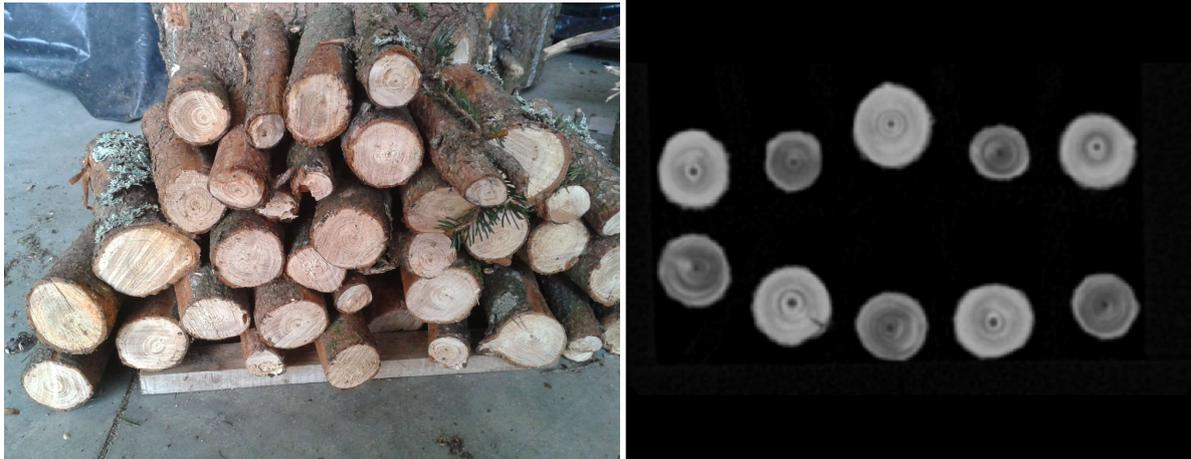
Figure 11 : Tronçons de branches assemblés en fagot (gauche) et exemple d'image scannée (droite).
